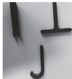
图 7 新型便携式挂钩的打印零件
